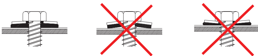
Obr. 28: Správné utažení šroubu.
